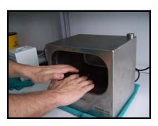
La correcta utilización del desinfectador se realiza colocando las manos en el interior, sin contactar con las paredes, techo o suelo metálico del aparato. Se debe esperar unos segundos a que comience la pulverización, que se inicia de manera automática.
