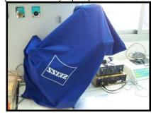
Fotografía 4. No cubrir la parte de ventilación de la lupa quirúrgica hasta que se produzca un enfriamiento de la misma después de su uso.
